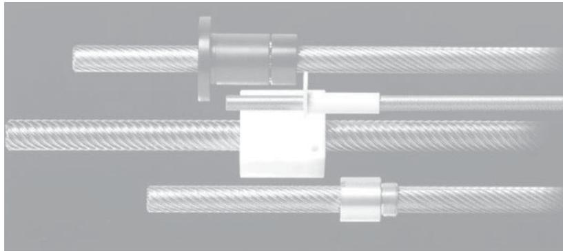
Dans les pages suivantes vous trouverez ces vis à pas rapide. Cette vis ultra rapide à filet roulés est fabriquée en acier (inoxydable ou non) ou en aluminium. Elle est appariée à des écrous en matière plastique POM hautement résistante à l'usure ou à des charges plus élevées à des écrous en bronze dans une exécution préchargée ou non. Pour des applications spéciales, des matières plastiques de haute qualité sont également utilisées pour les écrous.
